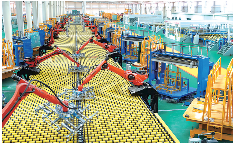
一窑三线切装工序现场,机器人自动抓片作业。王利涛 摄
