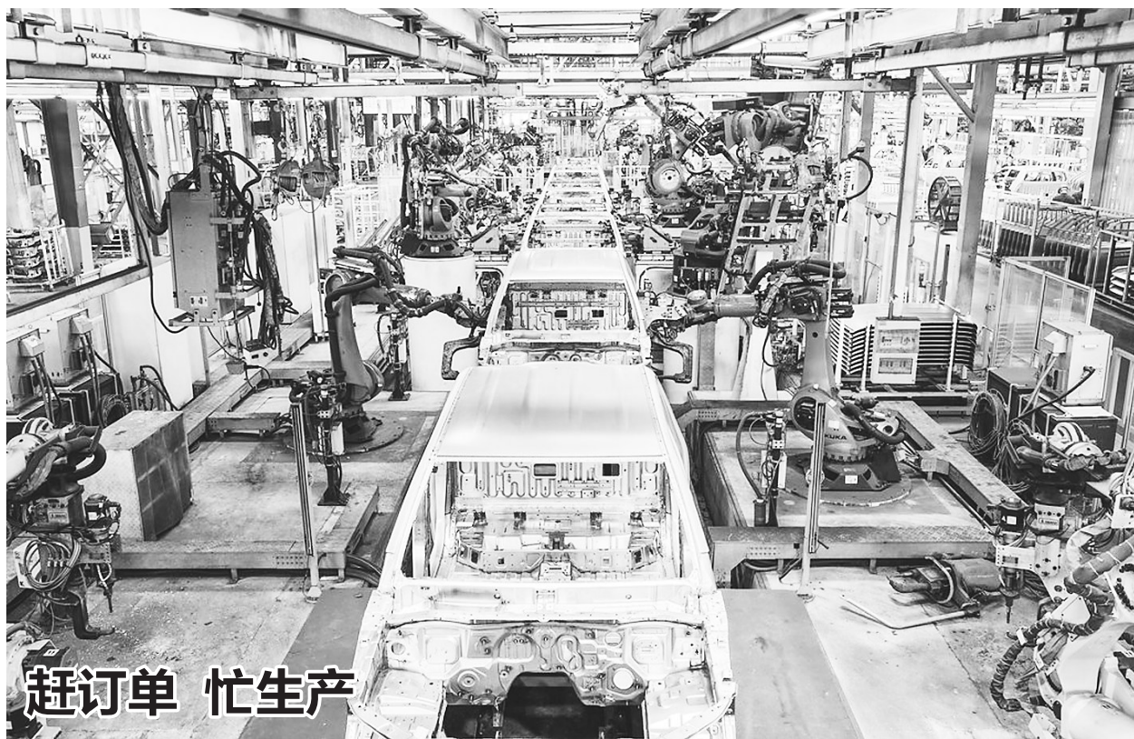
7月8日,河北长安汽车有限公司焊接车间,机器人在进行车身焊接组装。当日,河北长安汽车有限公司生产车间一派繁忙,工人们正抓紧赶制订单。
